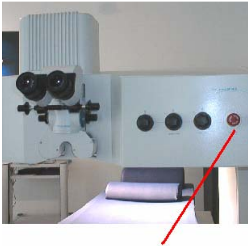
Interruptor de emergencia
